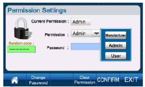
Разрешение пользователя, все функции, кроме воздействия на функцию измерения. Без разрешения, только операция установки тары и установки на ноль.
