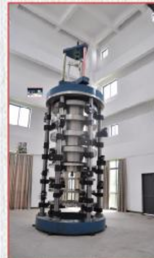
500kN静压式力标准机
